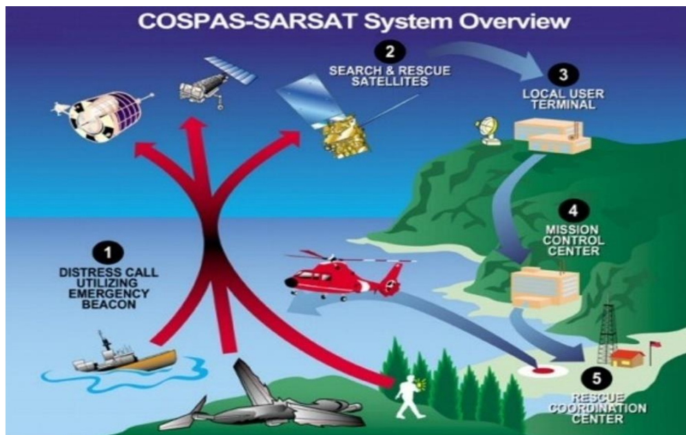
Principio de funcionamiento del Sistema de Rastreo Satelital Cospas-Sarsat
